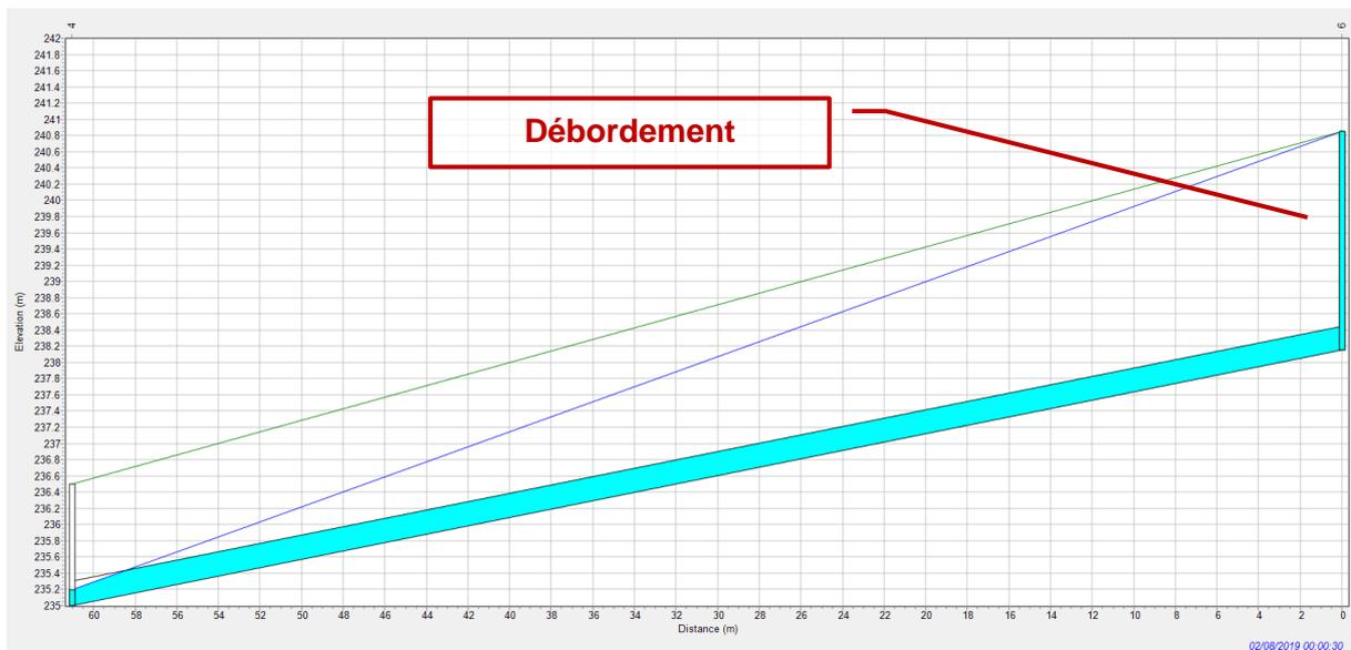
Figure 7 : Débordement des collecteurs amont sur un épisode centennal en DN300
